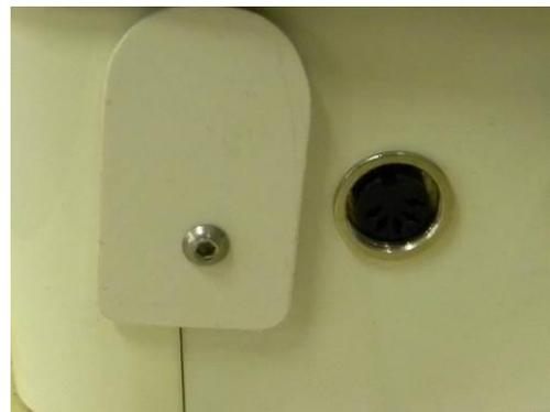
Prenez le câble des données et introduisez les connecteurs, en orientant les vis du connecteur vers le haut, puis vissez la bague de fixation.
