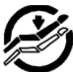
Commande de descente pantographe ;
