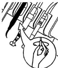
La regolazione dell'acqua allo spray si ottiene ruotando il rubinetto posto sotto il modulo dello strumento in senso antiorario per ottenere una graduale diminuzione del flusso d'acqua allo spray e viceversa ruotando nel senso opposto. Si raccomanda di non intervenire sulle altre regolazioni poste a fianco del rubinetto dello spray.
