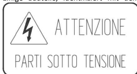
stehen auch nach dem Ausschalten des Hauptschalters unter Strom. Wenn Arbeiten an diesen Teilen durchgeführt werden müssen, muss die Stromversorgung der die Dental-Einheit versorgenden Anlage vor den Arbeiten getrennt werden.
