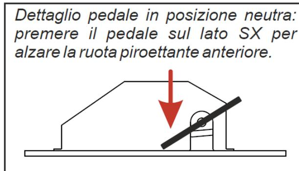
Détail de la pédale en position zéro : appuyez sur la pédale à gauche pour lever la roue arrière
