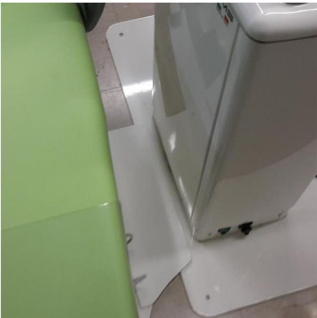
3. Positionner le fauteuil accolé à l'équipement en manière que les bases sur le côté plus court soient alignées dans la partie postérieure et en manière que les bases sur le côté plus large soient parfaitement parallèles. La plaque qui dépasse à gauche de la base du fauteuil doit être positionnée comme en photo.
