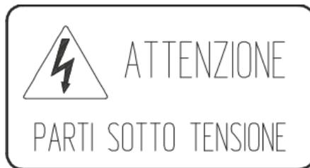
il est présent aussi la tension de réseau après l'extinction de l'interrupteur général, en cas on doit intervenir sur telles parties il est nécessaire d'enlever la tension à l'installation qui alimente l'appareil avant d'opérer.
